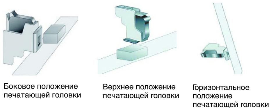
Рис. 3-25: Варианты установки печатающих головок
