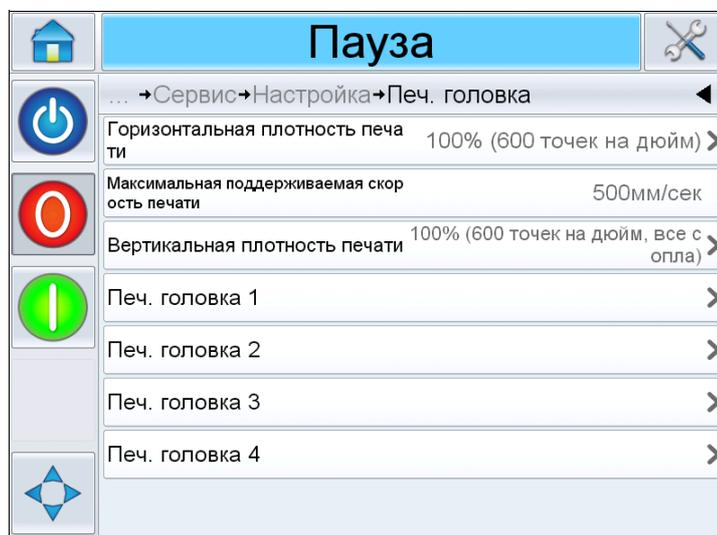
Рис. 4-4: Параметры печатающей головки
