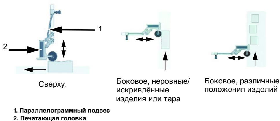
Рис. 3-47: Положения параллелограммного подвеса
