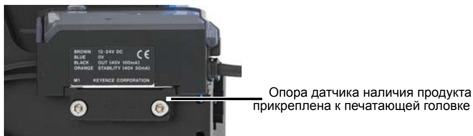
Рис. 4_36: Крепление опоры датчика наличия продукта к печатающей головке
